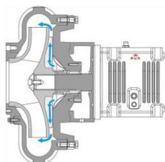
Обеспечивает вымывание абразивных частиц из зоны торцевого уплотнения и снижает осевые нагрузки на подшипниковые узлы насоса. Применяется для существенного увеличения срока службы торцевого уплотнения и снижения нагрузки на подшипники насоса.
