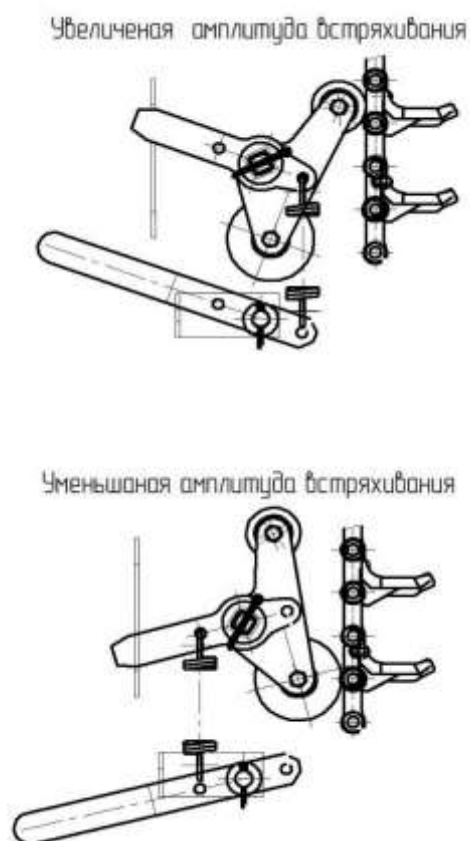
Рисунок 2 - Регулировка встряхивателя высаживающих аппаратов
