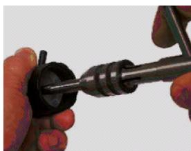
Поршень могут быть легко вынут при помощи ключа 3010-WR0008 с насадкой 3010-EX0004.
