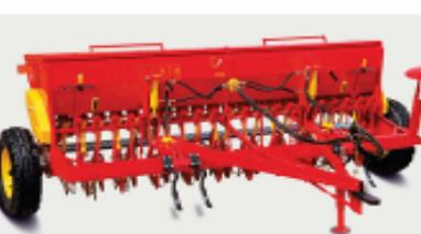
низкого веса сеялки (1350 кг) и оптимального размера бункеров (600 л для семян, 500 л – для удобрений) требующего меньшей тяговой силы трактора (одна сеялка – от 60 л.с.; 2-х сеялочный агрегат 8 м - от 80 л.с.; 3-х сеялочный агрегат 12 м – от 120 л.с.) и, соответственно, в 1,5-2 раза снижающего затраты на ГСМ; обеспечивающего высокую производительность (одна сеялка – 4,5 га/ч)
