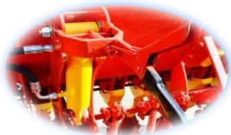
гидравлической системы заглубления, позволяющей усилить давление на сошник, используя весь вес сеялки и обуславливающей равномерность заглубления сошников
