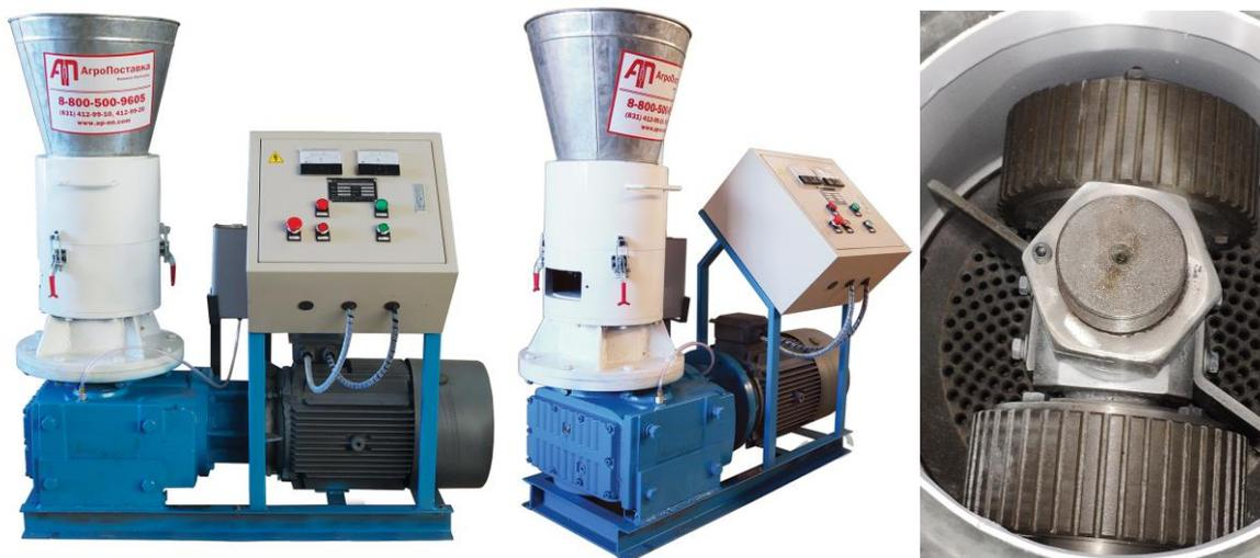
Грануляторы серии ZLSP (MZLP R-type) предназначены для переработки отходов агро и лесопромышленности влажностью от 12% до 20% и получения топливных гранул (пеллет). Подходит для обработки материалов, таких как: опилки, солома, шелуха, жмых и люцерна, жома сахарного тростника и т.д.
