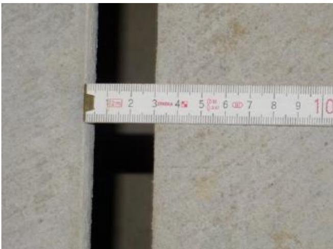
Обычные плиты для свиней на откорме (с 7 кг веса поросят) имеют ширину щели 30мм и оптимальную обработку края
