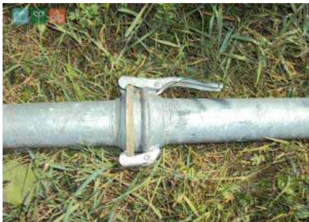
Рис. 10. Быстроразъемное соединение металлических труб
