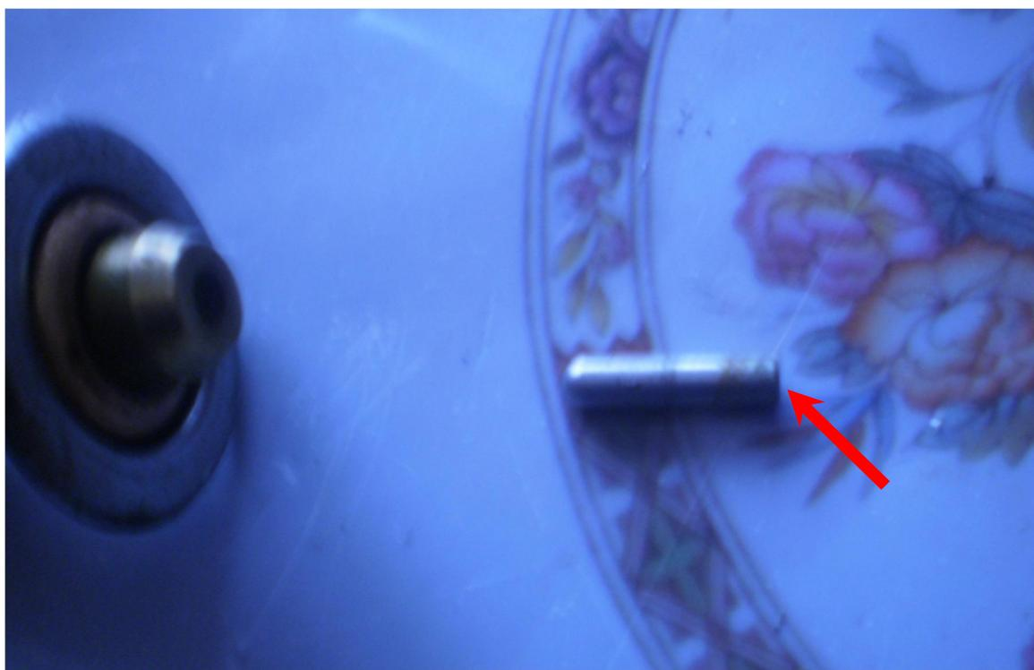
Укорачивать шток нужно до размера 17,5 мм, на фото шток подогнан под температуру 85 градусов, но не спешите. Далее в гнезде клапана полотном ножовки по металлу пропиливаем паз глубиной 1 мм (для выхода воздуха из пространства под термостатом когда будете заливать антифриз)
