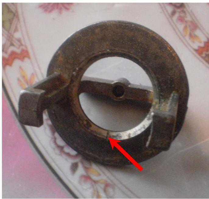
Собираем личину в обратном порядке и бросаем в кипящую воду чтобы клапан открылся. Экспериментальным путем установлено что он должен открываться не менее чем на 3 мм ибо двигатель в жару при хорошей нагрузке будет закипать. Если этот размер больше не спешите укорачивать шток. Установите личину на трактор и нагрейте двигатель, посмотрите какую температуру
