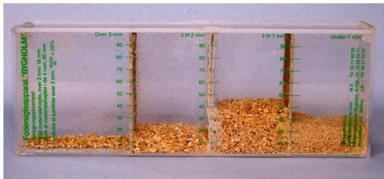
Сита для проверки степени измельчения кормового сырья
