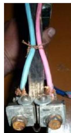
Вид с низу. Два т-образных кронштейна вырезаны болгаркой из подходящего куска стали, скреплены между собой болтами М6, на которые предварительно одеты кембрики, (дабы избежать короткого замыкания) а под металлические шайбы подложены пластиковые шайбы, вырезанные из канистры под моторное масло.
