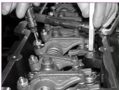
RG13946-UN: Проверка зазора клапана с помощью толщимомера
