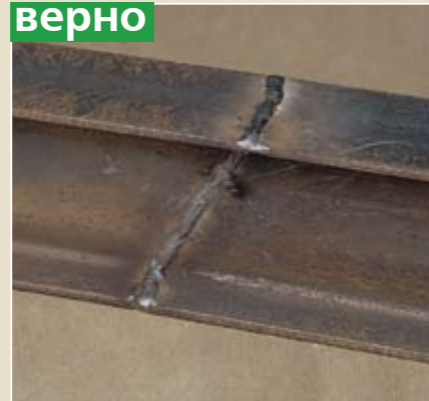
Косой срез обеих половин обеспечивает высокую прочность соединения.
