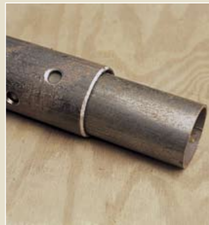
На рисунке изображен подходящий усиливающий элемент, который проталкивается в трубу и приваривается к ней через отверстия.
