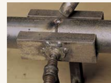
Важно: приварите U-образный профиль сначала к неподвижной губке струбцины. Затем установите в него кусок трубы и сверху еще один профиль. Зажмите струбцину и приварите второй профиль. Оба U-образных профиля приварены теперь безупречно ровно относительно друг друга.
