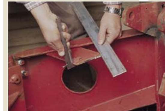
Если такой широкий стальной лист заменяется более узким, новый усиливающий элемент должен быть значительно толще. Пример: если ширина оригинальной детали 100 мм, а толщина 5 мм, ее замена при ширине 50 мм должна иметь толщину 10 мм.
