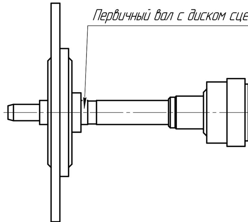
*Одеть втулку или наплавить с последующей обработкой для посадки под подшипник, размер уточнить сопрягая с подшипником при механической обработке*
