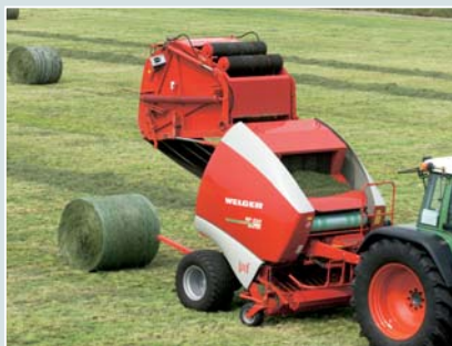
Благодаря 23 ножам потребляемая мощность отчасти меньше чем у других пресс-подборщиков с меньшим количеством ножей
