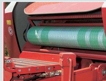
Чтобы заложить рулон сетки, водителю нужно взобраться на пресс-подборщик.
