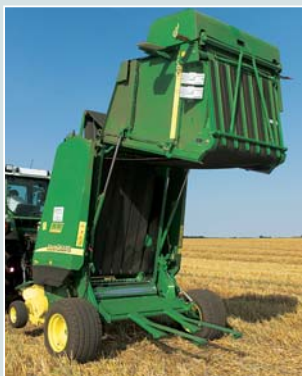
592-я модель весит лишь 3 тонны, и при движении по дороге на скорости 40 км/ч ей не нужен тормоз.
