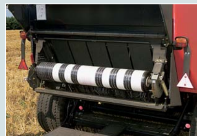
Практичное расположение рулона сетки в грузовом люке в задней части.
