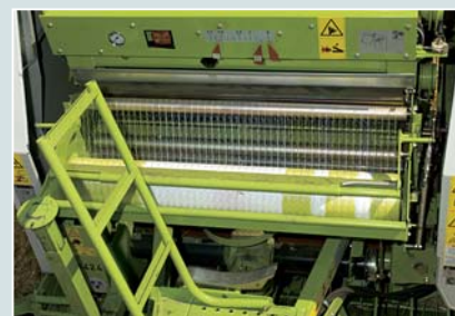
Чтобы вложить рулон сетки в гнездо, водителю нужно забраться на пресс-подборщик.
