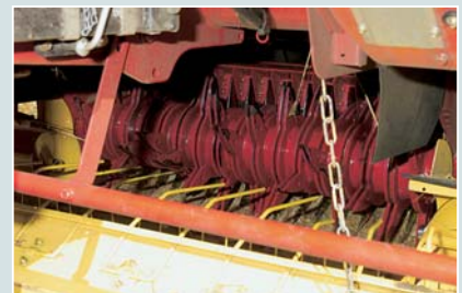
До 15 ножей между ротационными зубьями режут прессуемый материал очень мелко.
