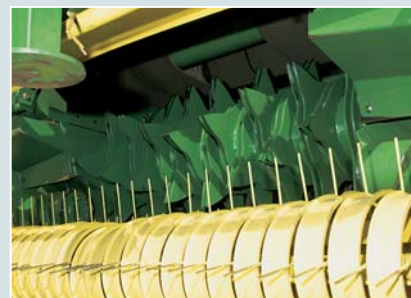
Полный реверс может на полной мощности прокрутить ротор назад.
