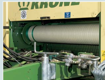
Рулон сетки закладывается спереди на удобной высоте.
