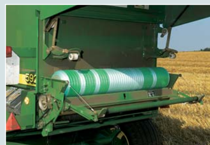
Рулон сетки просто закладывается в грузовой люк задней части.
