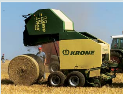
Vario Pack был единственным образцом, который в качестве прессующих аппаратов имел стержневые цепи вместо пресс-шківов.
