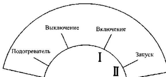
Рис 4—1. Схема положения выключателя запуска
