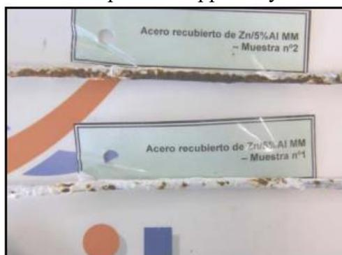
**864 часа.** Красная коррозия двух образцов из оцинкованной стали усиливается.
