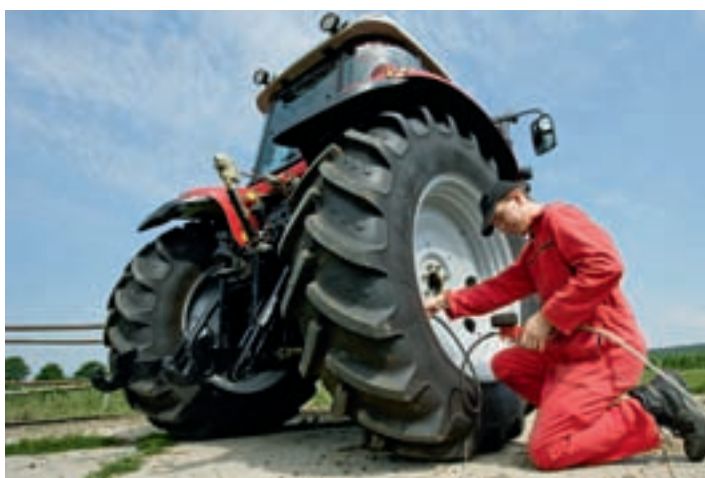
Внутреннее давление в шине оказывает влияние и на ее долговечность.
