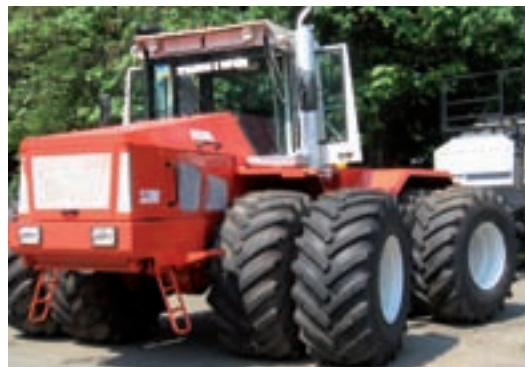
Спаренные шины позволяют значительно уменьшить давление на почву и тем самым сохранить ее структуру.
