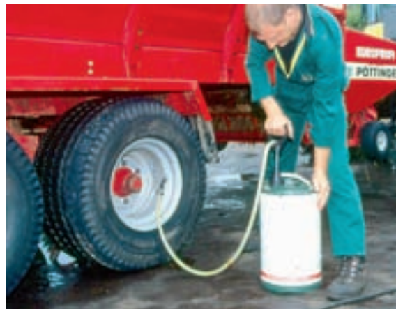
Залитая в качестве балласта незамерзающая жидкость обычно остается в колесе на весь срок службы шины. Жидкость в шине не имеет никакого отношения к балансировке колеса и используется лишь на тракторной технике.
