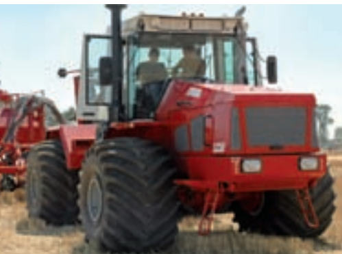
Благодаря более тесному соприкосновению шины с почвой тяговое усилие трактора на широкопрофильных шинах возрастает на 15-20%.
