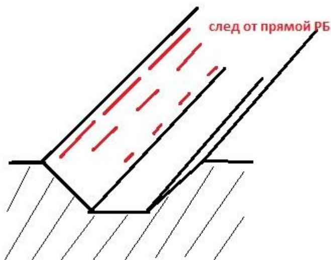
4. Что бы повысить эффективность работы, и что бы была возможность подстраивать поверхность РБ у углам наклона гряд, делается угол между катками РБ. Так если бы была возможность вращать угловую РБ на 180 градусов то можно было бы обрабатывать гряды с углами от Минимального
