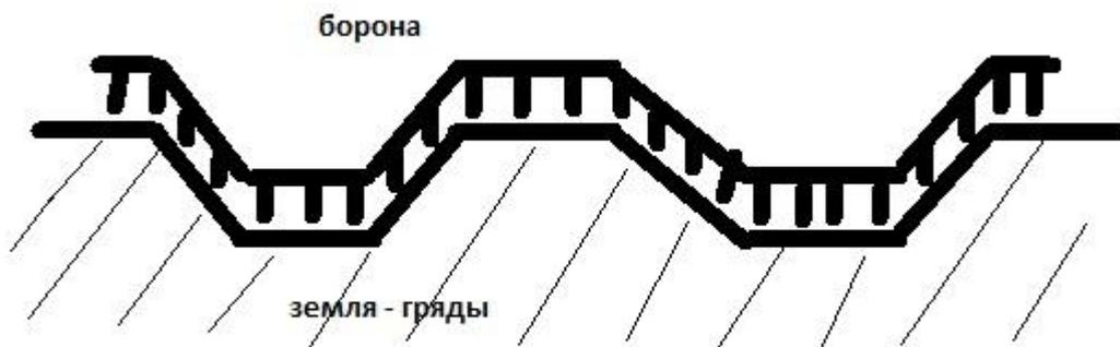
3. Как разновидность жесткой бороны имеющей форму гряды можно рассматривать и Ротационную борону (РБ). Кстати ротационная борона (без угла- «прямая») тоже будет работать как обычная борона (зубья диска меньшего диаметра будут «волочиться») за счет разницы в длине окружности дисков.
