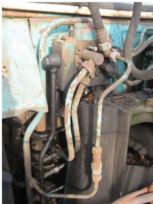
Рис. 3. Клапан защиты гидроцилиндра стрелы
