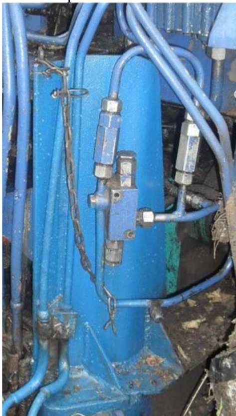
Рис. 2. Защита гидравлических линий механизма поворота колонки
