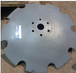
Диски борон изготовлены из высокопрочной стали с последующей закалкой, а режущие кромки дисков механически обрабатываются, что обеспечивает низкий уровень износа дисков и длительный срок их службы.
