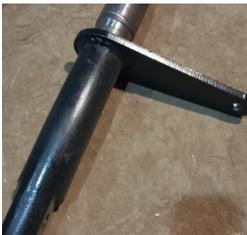
Смазываемая стойка диаметром 58 мм.
